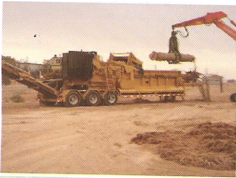
آلة فرم للتخلص من بقايا النخيل المصاب وأطوار السوسة Pulverizing machine to eradicate severely infested palms
